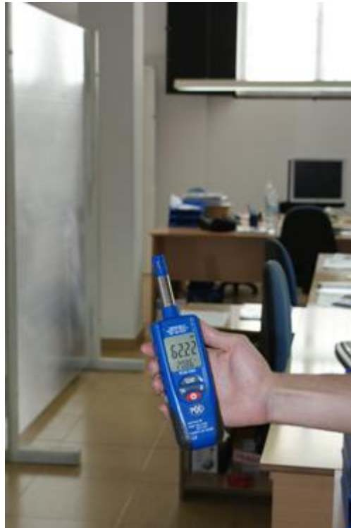
Vista frontal do higrômetro PCE-555, realizando uma medição no interior da umidade.
