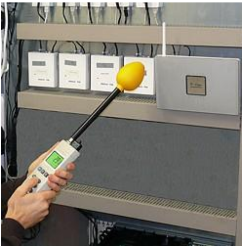
O medidor de campo eletromagnético se utiliza p.e. para detectar o Wireless LAN
