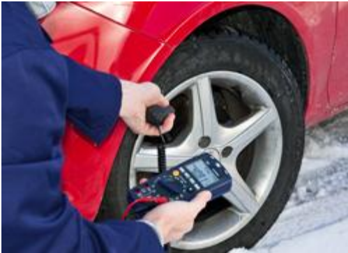
Medição da temperatura mediante o adaptador externo de temperatura infravermelho
