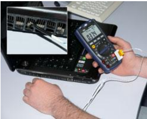
O medidor multifunções verificando uma medição de temperatura com uma sonda tipo K
