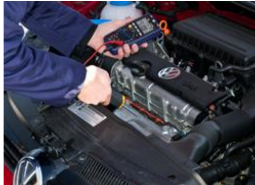
Comprovação da temperatura dum motor com o medidor multifunções PCE-EM 886
