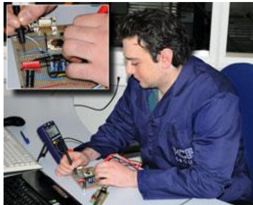
O medidor multifunções PCE-EM 886 verificando uma medição com a função multímetro
