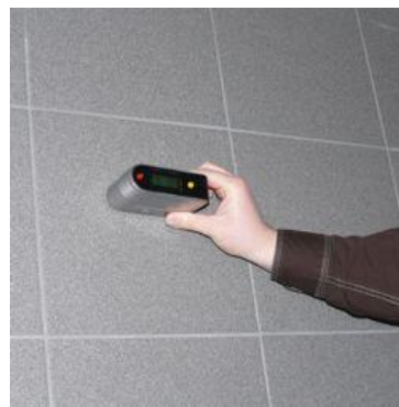
Aqui vê o brilhômetro PCE-GM 50 a medir a superfície de azulejo.
