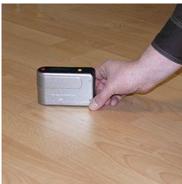
Aqui observa o brilhômetro PCE-GM 50 a medir uma superfície envernizada.
