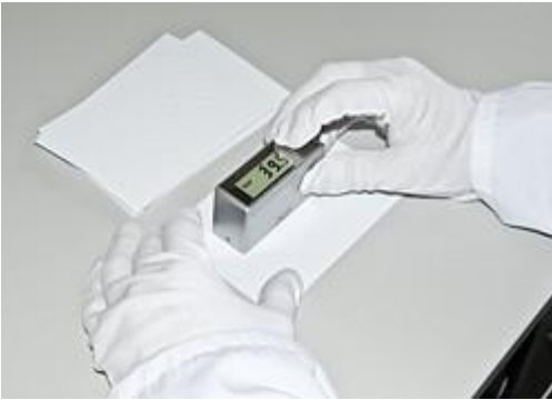
O brilhômetro PCE-GM 60 a medir uma superfície envernizada.
