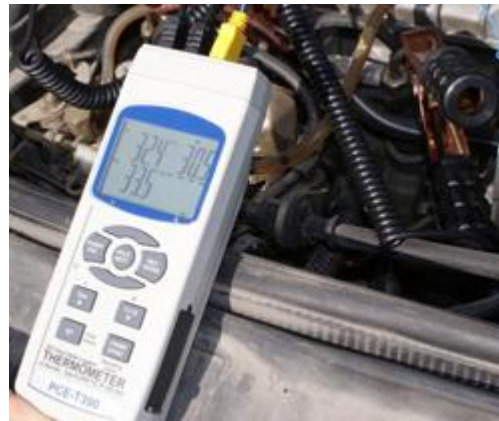
A medir a temperatura do motor dum carro com o termômetro e uma sonda de vareta.
