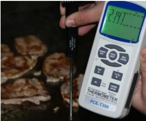
A realizar uma comprovação da temperatura numa grelhador com o termômetro PCE-T 390
